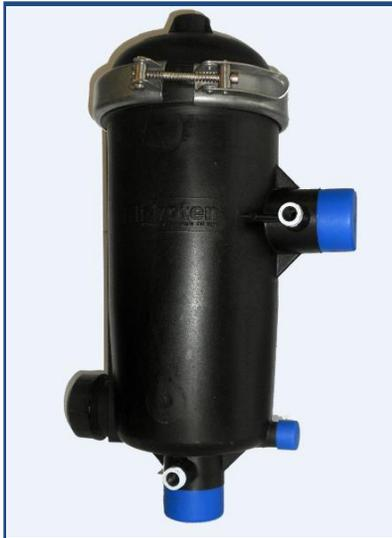
EN LOS FILTROS DE MALLA EL AGUA SE FILTRA DESDE LA PARTE INTERIOR A LA EXTERIOR, POR TANTO LAS CONEXIONES DE ENTRADA Y SALIDA SON INVERSAS A LA DE LAS DE ANILLAS.
