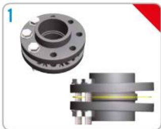
1. Modo incorrecto de apriete. / Incorrect tightening mode.
